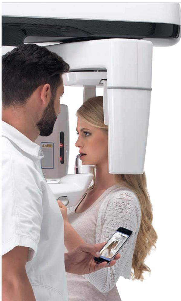
Grâce à la connexion Ethernet, NewTom GO peut être commandé à distance à l'aide d'un panneau de commande virtuel intuitif et facile, à utiliser sur PC ou via l'application également disponible pour iPad. L'application permet de sélectionner le type de balayage désirée et d'afficher le résultat en temps réel pour vérifier immédiatement le résultat de l'examen. L'application permet de modifier la luminosité et le contraste de l'image, de l'agrandir et de la faire pivoter.
